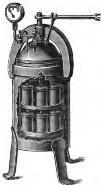
Fig. 230. — Autoclave pour le dosage de l'amidon.
